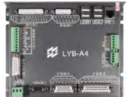
零壹激光焊接系统控制板卡
